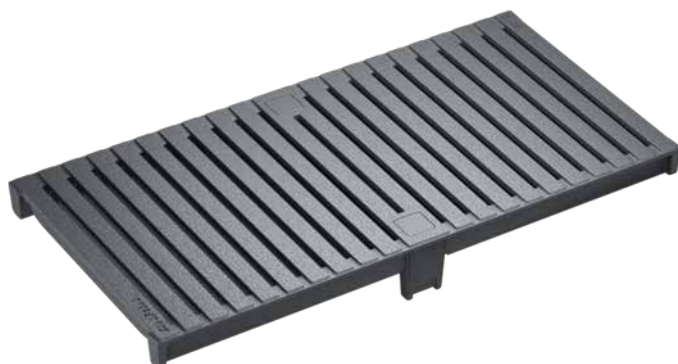
Galler, HEELGUARD, Gjutjärn GJS, KTL behandlad, svart lackerad Belastningsklasser: D400* , Längd: 50 cm, SW 6 mm
