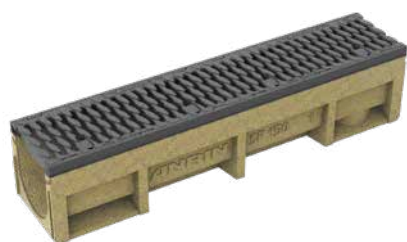
SF-150 Rännor kombinerat med gjutjärnsgaller Bk. D400 1 -E600 1 ; F900 1
