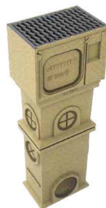
sandfång-ovandel kombinerat med gjutjärnsgaller Bk. D400 1 -E600 1 ; F900 1
